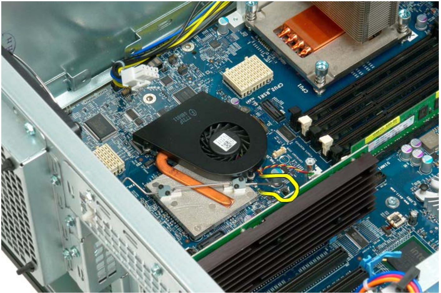
6. Fjern chipset-blæseren fra computeren.
