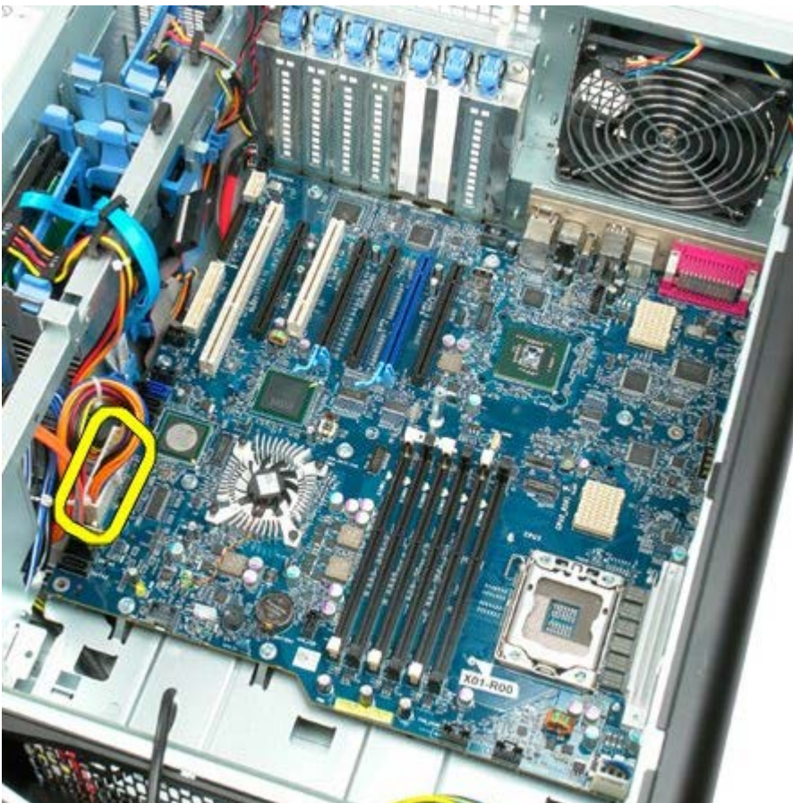
17. Frakobl datakablet til det optiske drev.
